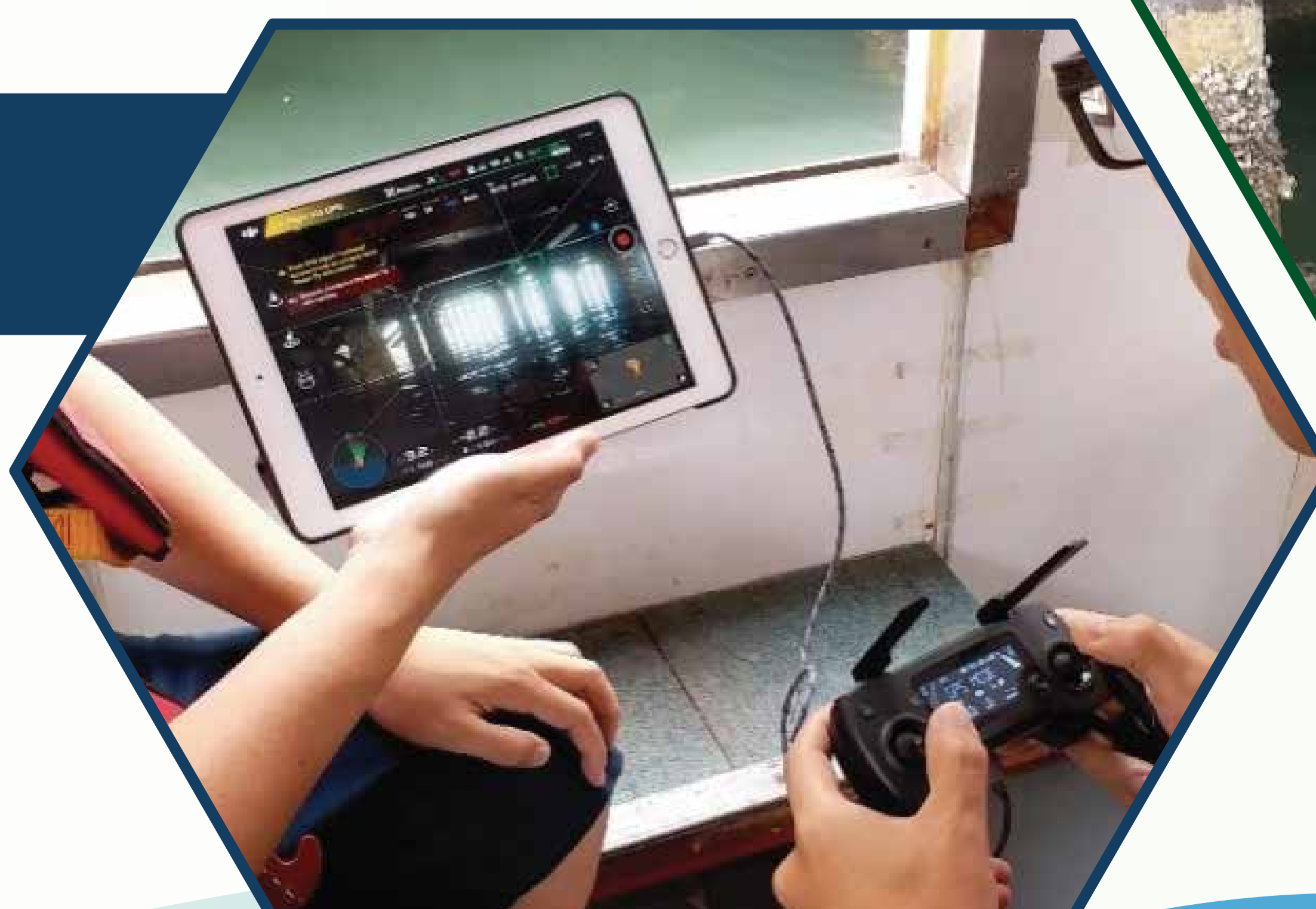
利用無人機拍攝碼頭承台結構的高解像度影像
